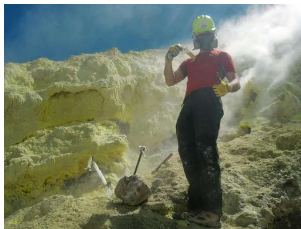
Figura 4: Toma de muestra de gases utilizando la botella de Giggenbach , por parte de Francesco Capecchiacci de la Universidad de Florencia, Italia. Fotografía: Gino González.
