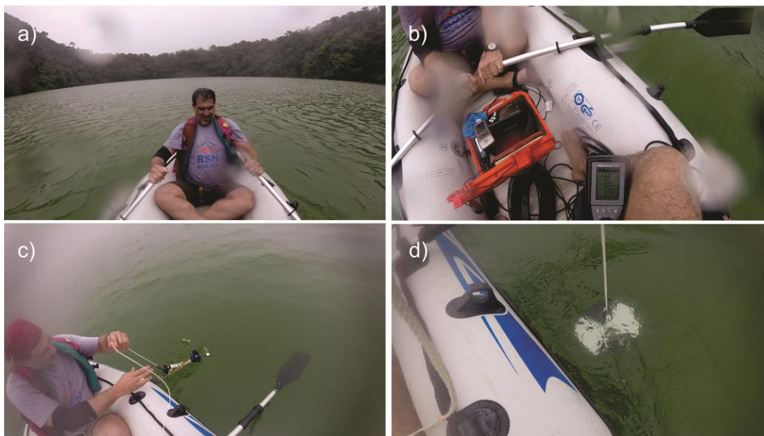
Figura 10: Trabajo de campo en Laguna Chato. a) Remado en gran parte del lago. b) Toma de datos con el sonar (caja color naranja) y sonda multiparamétrica. c) Muestreo en profundidad con una botella Wildco. d) Uso del disco secchi para la medición de turbidez Fotografías de Gino González.
