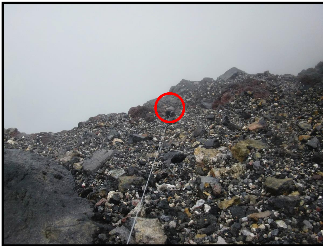
Figura 11: Cuerda de nylon con una botella amarrada (círculo en rojo) en la cual se recolecta muestra del lago del cráter activo. Fotografía de Gino González.
