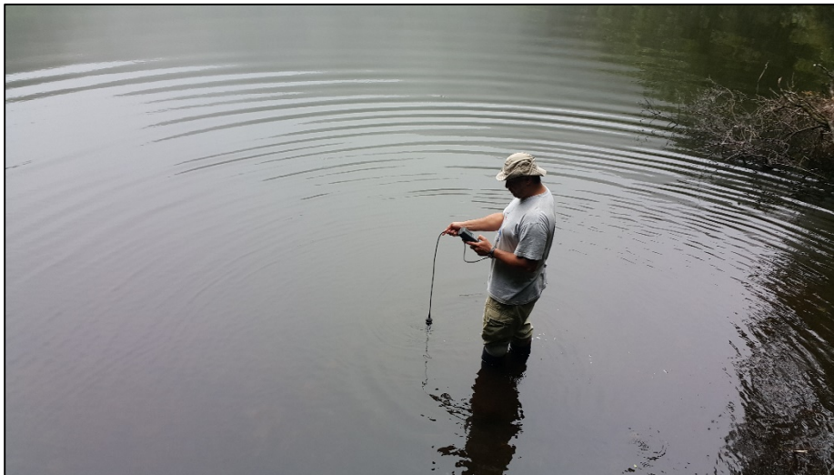
Figura 6. Carlos Ramírez realiza mediciones de parámetros físico químicos en la laguna del volcán Barva con una sonda multiparamétrica. Fotografía de Raúl Mora-Amador.
