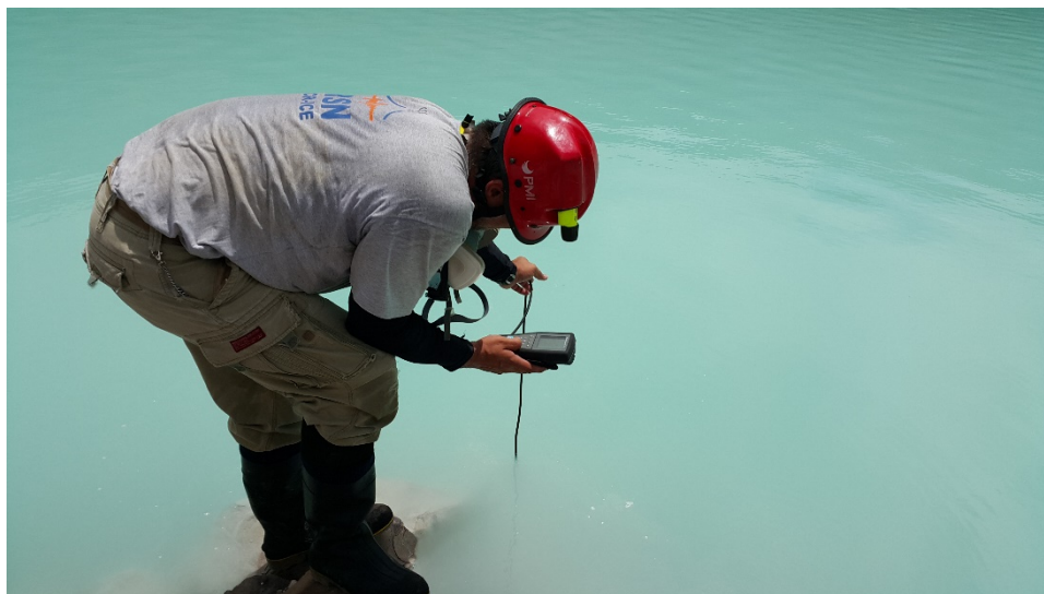
Figura 9. Laguna caliente del volcán Poás. Carlos Ramírez realiza mediciones de temperatura y grado de acidez de la Laguna Caliente (fotografía Raúl Mora-Amador).
