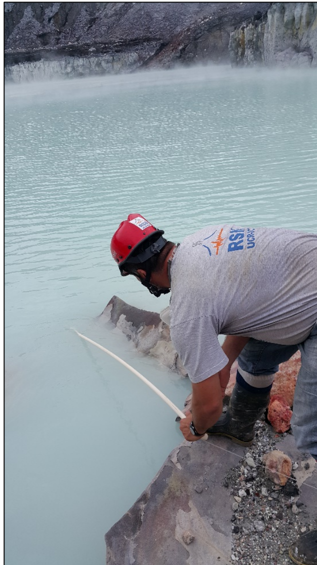
Figura 5. Carlos Ramírez coloca termómetros en la Laguna Caliente del volcán Poás. Fotografía Raúl Mora-Amador.
